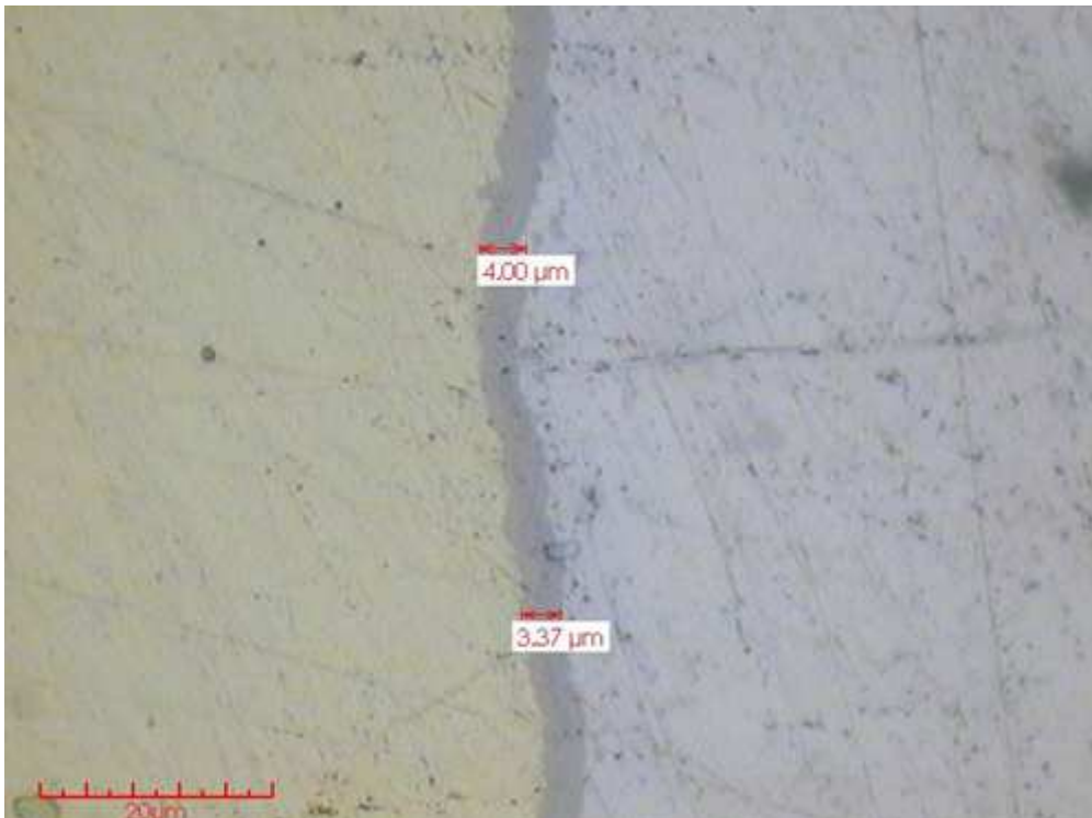
Schliff 1: Detailansicht der Lötstelle mit Vermessung der IZ und Bemerkungen
